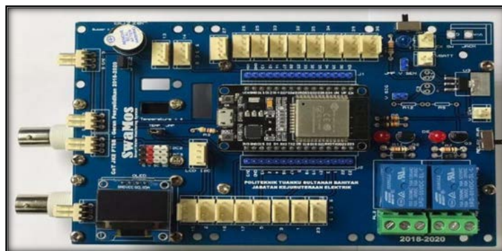
Rajah 4: Prototaip papan litar utama
